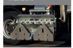
Système modulaire à 4 boulons permettant la collecte d'une large gamme de conteneurs de 60 à 1100 L
