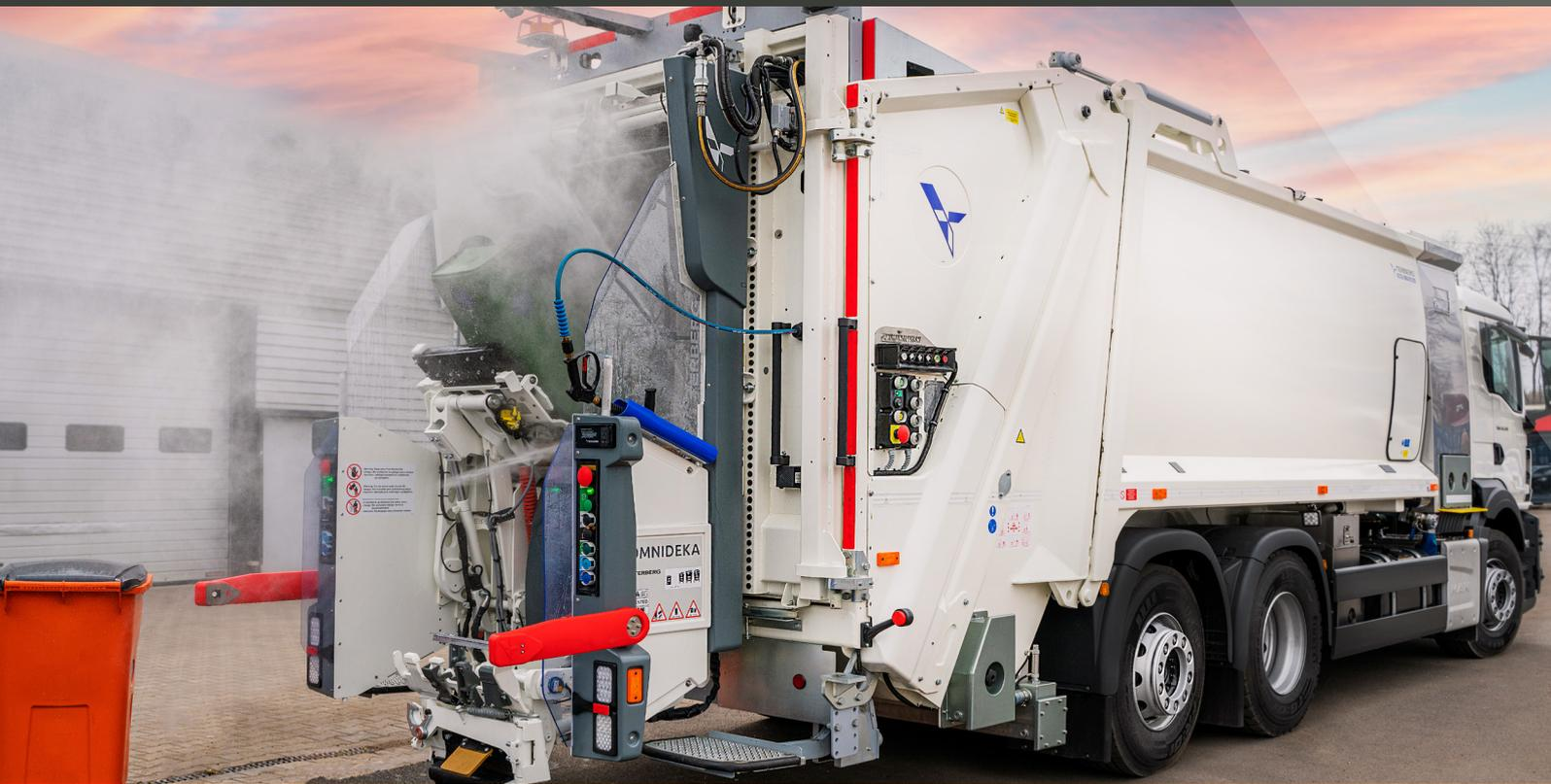
Dispositif haute pression monté sur benne Olympus Terberg pour le lavage et la désinfection des conteneurs à déchets.
