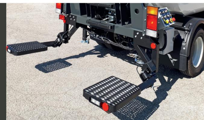
Marchepied(s) homologué(s) pour l'opérateur (si châssis correctement prédisposé).
