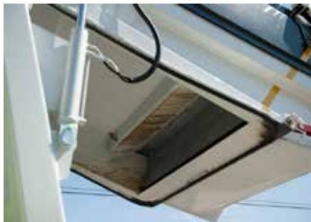
1 Joint d'étanchéité sur l'ensemble du périmètre de contact entre la benne et la trappe arrière, jusqu'à la hauteur maximale.
